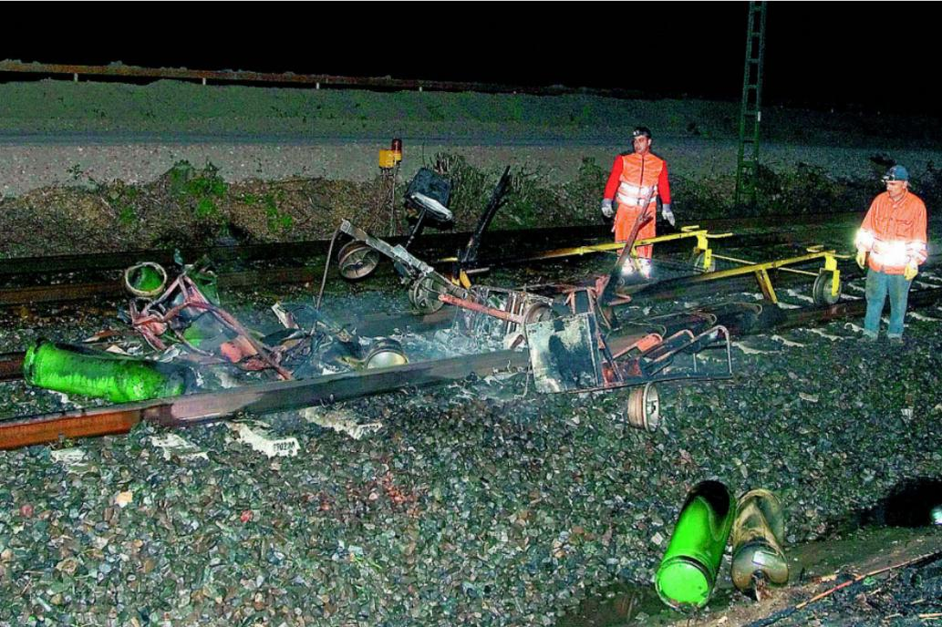
Völlig zerstört wurde die Schienenwärmemasschine der Bahn, auf der sechs Propan-Gasflaschen lagerten.
