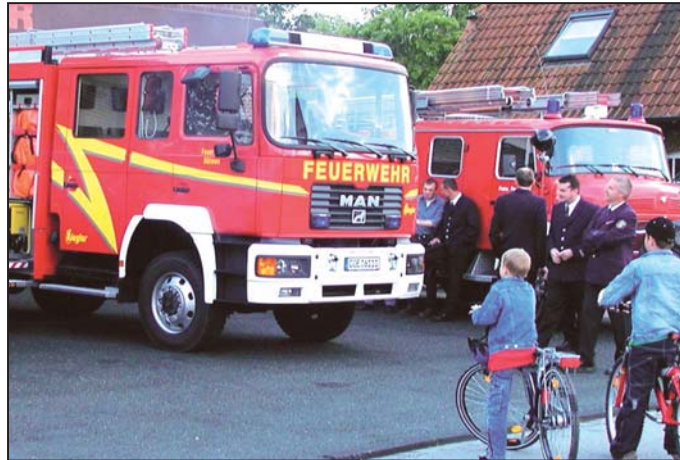
Das Fahrzeug wird mit einer Leistung von 206 kW (280 PS) angetrieben.
